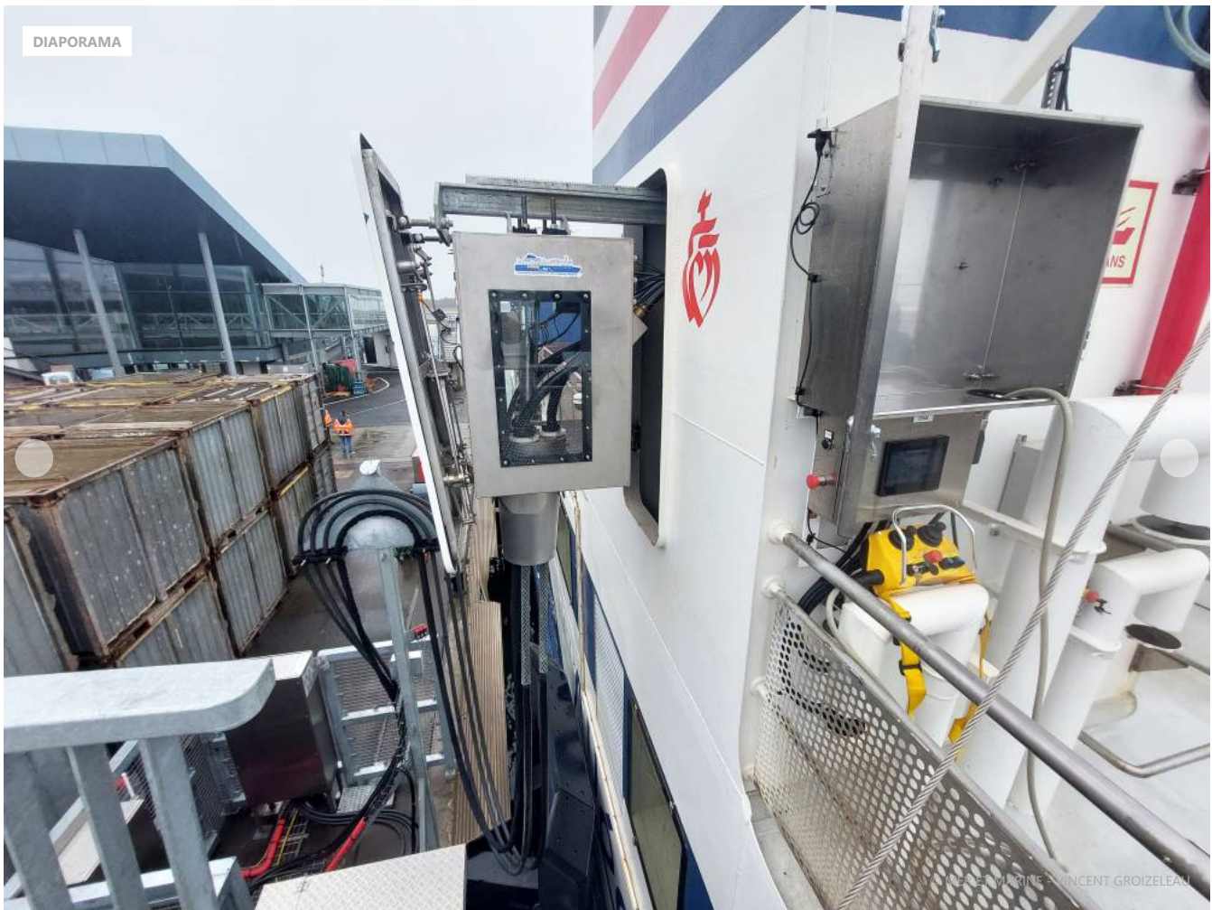
Le système de branchement à quai PLUG de NG3 ici à la gare maritime de Fromentine.
